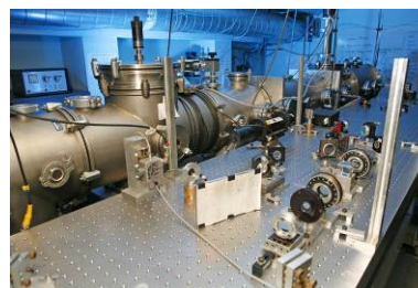
Chambre à vide de l'expérience d'interférométrie atomique
